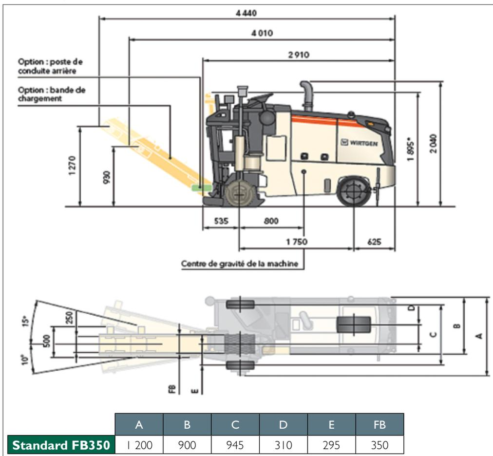
**Cercles de fraisage de la W 35 Ri** - Profondeur de fraisage 50 mm - Dimensions en mm
